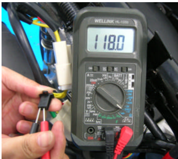
図 23 クランクポジションセンサー抵抗値測定
