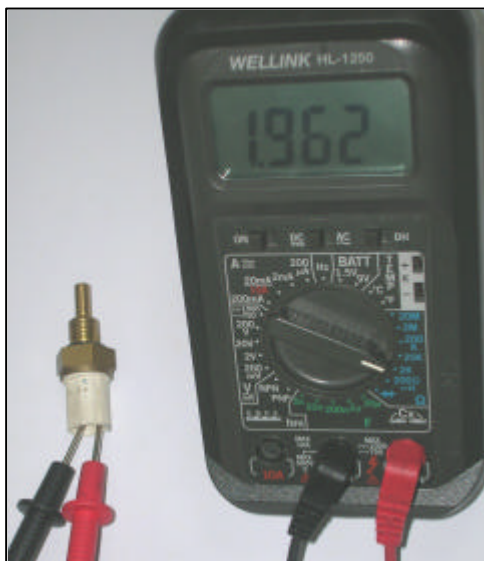
図 8 エンジン温度センサー抵抗測定方法
