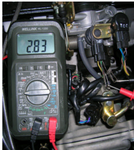
図 4 PM Sensor 平地出力電圧点検
