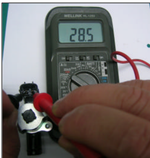
図 25 エアインジェクションソレノイドバルブ抵抗値測定
