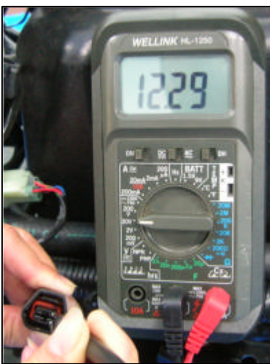
図 15 燃料ポンプ作動電圧測定およびカプラー端子図
