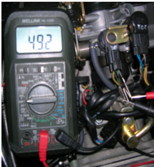
図 3 PM Sensor 作動電圧点検方法
