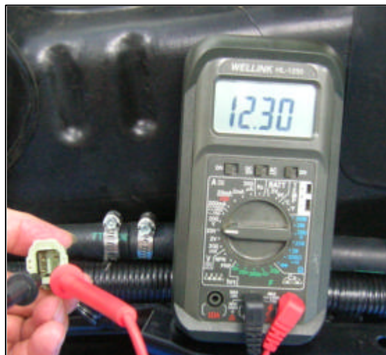
図 11 O 2 Sensor ヒーター作動電圧測定
