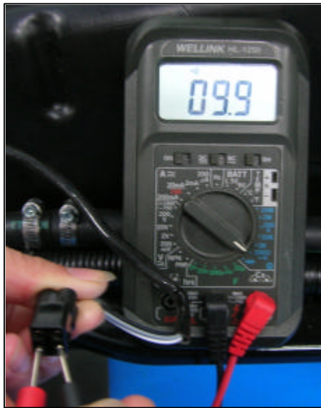
図 13 O 2 Sensor ヒーター抵抗測定
