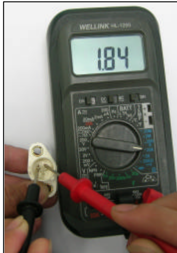
図 24 吸気温度センサー抵抗値測定
