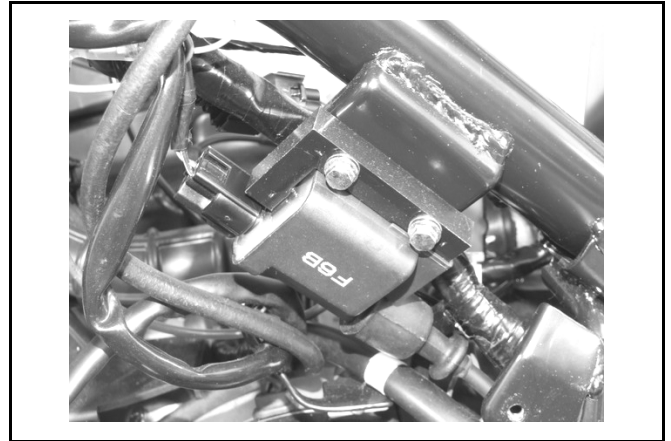
點火線圈一次迴路 0.5\Omega \sim 0.8\Omega 註： 0.63\Omega (23°C)
