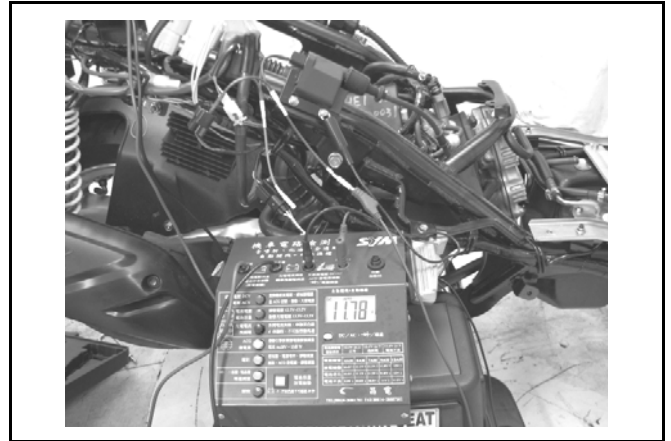
點火線圈一次迴路 0.5 \Omega \sim 0.8 \Omega 註： 0.63 \Omega (23^\circ\text{C})
