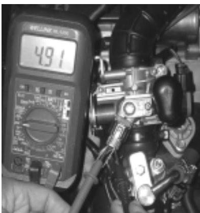
工作電壓量測
