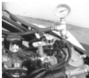
燃油系統燃油壓力量測
