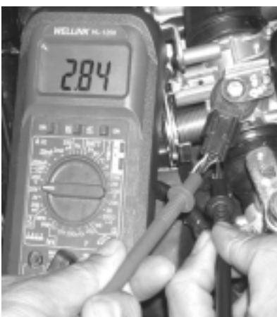
平地輸出電壓量測
