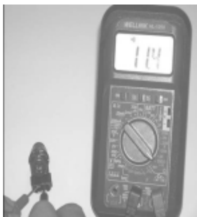
噴油嘴電阻值量測
