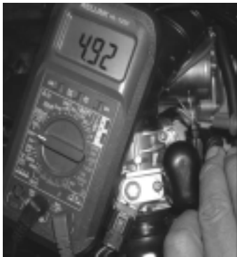
工作電壓量測
