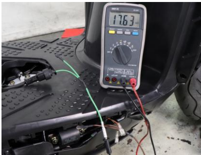
二次線圈端子電阻值量測
