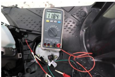
燃油泵工作電壓量測
