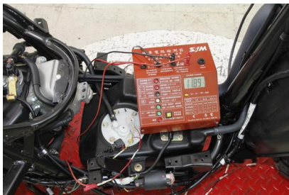
燃油泵工電壓量測
