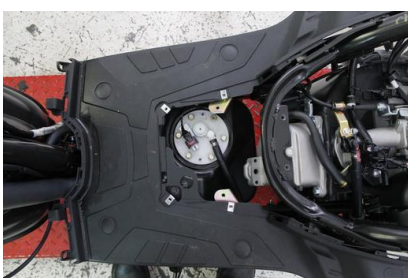
燃油壓力量測拆卸處-燃油泵
