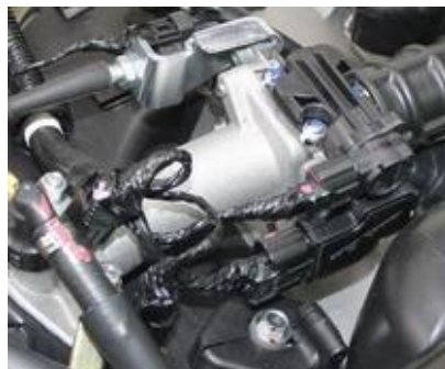
燃油壓力量測拆卸處-噴油嘴
