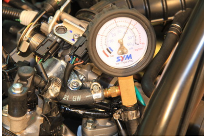
燃油系統燃油壓力量測
