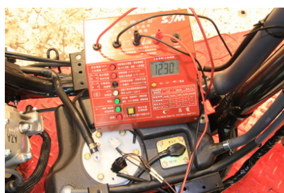
燃油泵工作電壓量測
