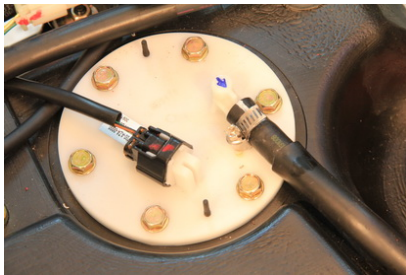
燃油壓力量測拆卸處-燃油泵
