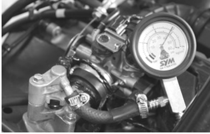
燃油系統燃油壓力量測
