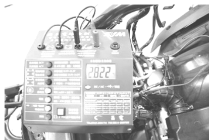
平地輸出電壓量測
