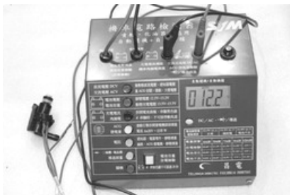
噴油嘴電阻值量測
