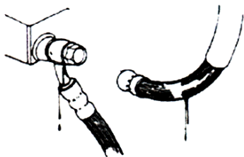
(ブレーキの漏れ、損傷、緩み)
