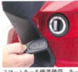
スマートキーを標準装備。キーフォブにある開錠ボタンでスイッチノブのロックを解除して始動するシステムとなっている。
