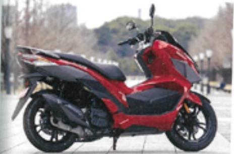
フラットなステップフロアではなく、トンネルを備えたセンターフレーム方式を採用して車体剛性を大きく向上させている。
