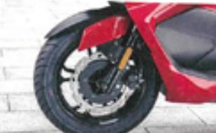
フロントブレーキローターは260mm径と大きい。ABSは非装着だが、前後運動ブレーキを採用して制動力を高めている。
