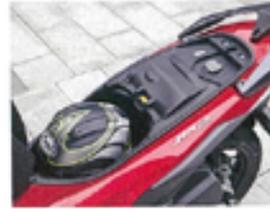
トランクはヘルメットを1個収納可能。後部の給油口はキー不要で開閉が可能なもの。タンク容量は7.5リットルと大きい。
