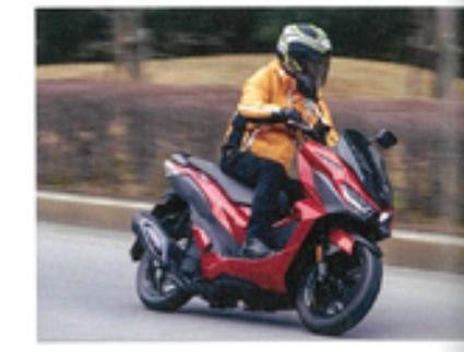
水冷単気筒のエンジンは振動/騒音とも抑え込まれていてガサ付き感はなく、信号待ち時やクルージング中の感触は日本車にも引けを取らない上質なもの。クラッチが繋がりは始めるのは約3500回転で、全開加速では6000回転後半をキープして140kgの車体を押し出すスポーティーなセッティングになっている。その車格から、試乗前はもつと穏やかな反応を想像していたが、発進停止の多い市街地を俊敏に駆け回れる設定だ。
