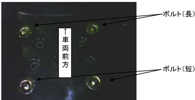
ワッシャーを取り付けてボルトで固定する。
