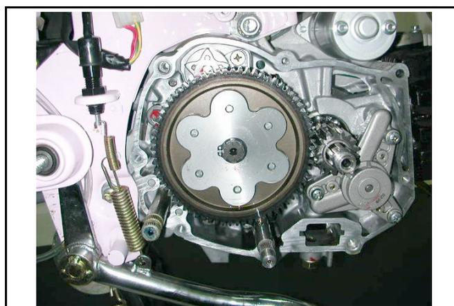
夾開最初傳動齒輪夾環，取下最初傳動齒輪及軸環。
