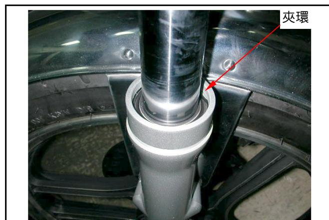
將新的油封內唇塗佈避震器油後，套入前避震器導桿。
