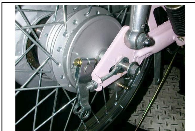
將後輪軸抽出後，即可拆下後輪、輪軸右側襯套、鏈條調整器及後剎車盤。
