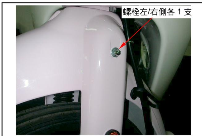
拆下前擋泥板 A 上方螺栓(螺栓×1)。
