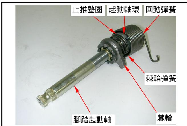
將腳踏起動軸及棘輪組，裝入左曲軸箱，回動彈簧末端鉤處，勾上左曲軸箱擋塊上。
