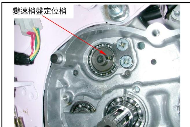
對正變速梢盤後之定位孔，將變速梢盤及變速梢裝上變速鼓。
