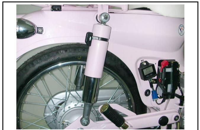
檢查兩側避震器彈力調整器，是否調整再同一緊度。
