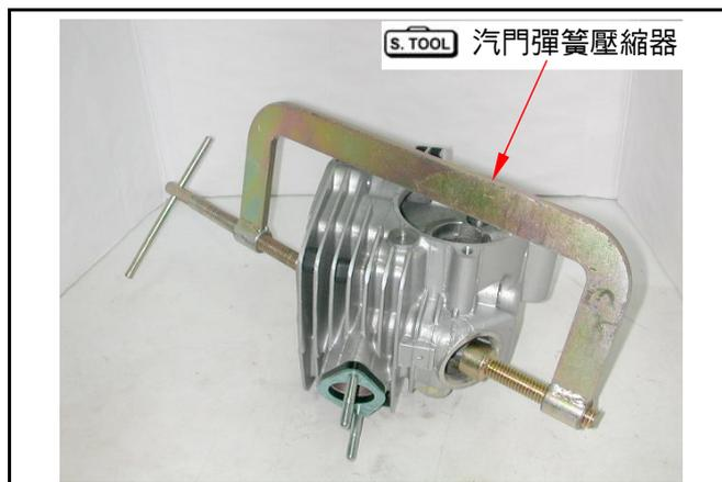
您亦可選擇使用汽門彈簧拆/裝器來拆除彈簧。清除燃燒室內的積碳，使用汽門彈簧拆/裝器直接壓下彈簧後，取下固定釦、彈簧座及彈簧。
