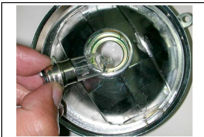
將頭燈組對正裝上頭燈罩，鎖緊頭燈下方頭燈組固定螺絲(螺絲×1)。
