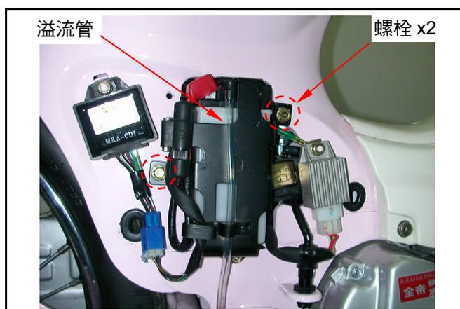
拆下起動馬達電源導線。
