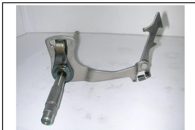
檢查變速鼓制止器及回動彈簧，是否磨耗或損壞。
