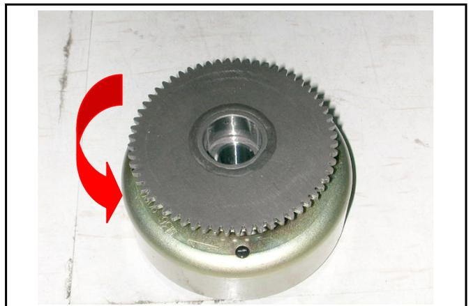
檢查起動被動齒輪是否磨損或損傷。
