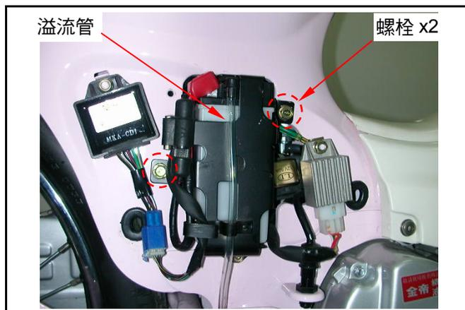
若電瓶液面過低時，請拔開電瓶頂端塞子，補充蒸餾水至上限位置。
