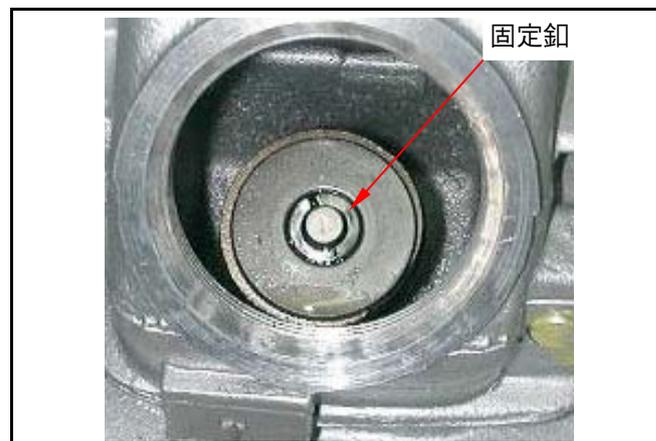
使用汽門彈簧壓縮器壓下彈簧後，拆除汽門固定釦，取下彈簧座及彈簧。
