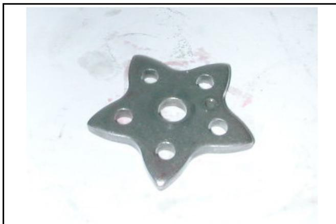
檢查變速梢盤及變速梢，是否磨耗或損壞。
