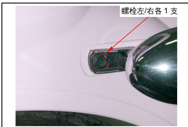
拆下牌照架(螺栓×2)。
