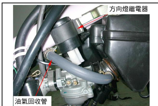
反時針方向旋開化油器頂蓋，拆下節流閥及加油導線。
