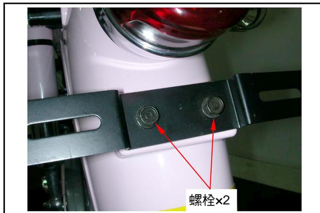
拆下後架後，先拆下左/右後方向燈組，再將擋泥板拆下(螺栓×1、螺絲×1)。
