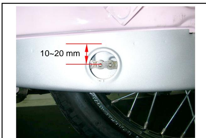
先鎖緊傳動盤螺帽，再鎖緊後輪軸螺帽。
