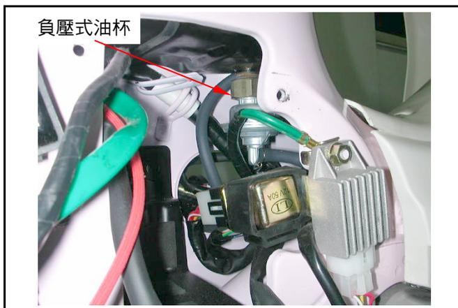
將負壓式油杯上之出油管及負壓管拆下。
