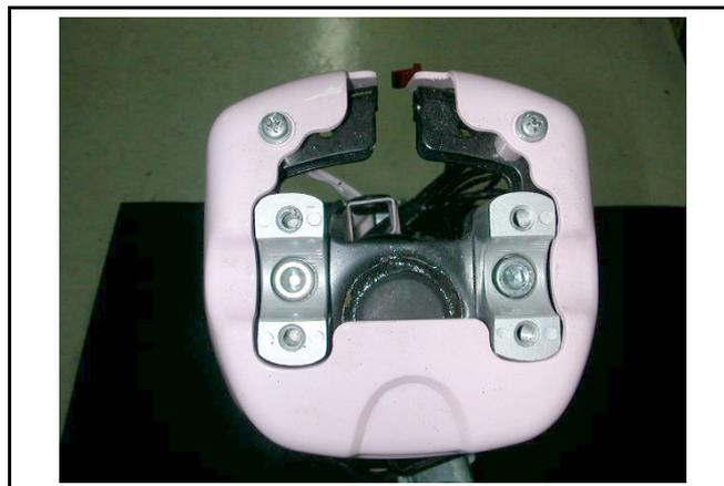
在組裝把手開關座、節流把手、節流導線時，須在把手作動處塗抹黃油。
