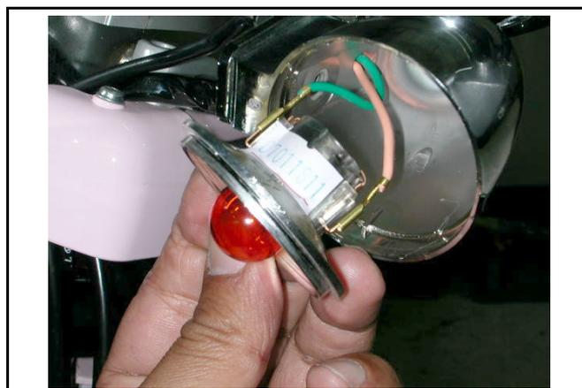
**尾燈 / 剎車燈 / 牌照燈拆換**
