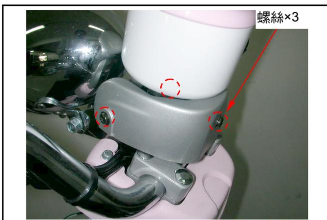
拆下儀錶護蓋架及儀錶固定架(螺栓×2)。
