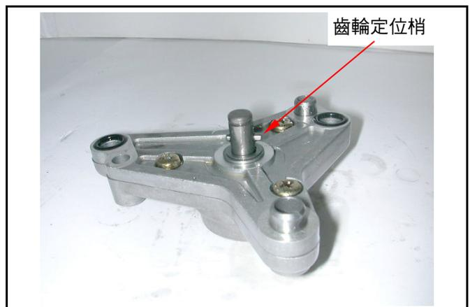
拆下機油泵蓋(螺絲×3)。
