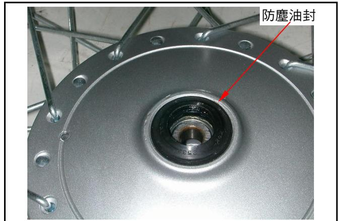
檢查剎車盤內側防塵油封有無破損、龜裂，若有異常請更換新品。
