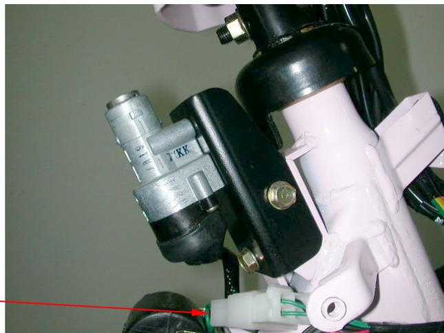
二次空氣導管及方向燈繼電器導線固定在固定夾內
