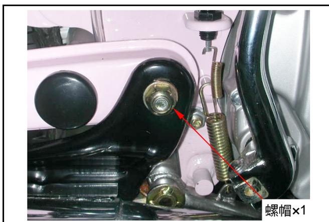
拆下剎車定位臂螺栓上之開口梢後，拆下剎車盤定位臂(螺帽×1)。
